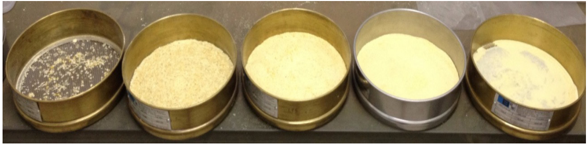
Figura 2. Farelo de milho após a separação em peneiras, da esquerda para a direita as frações 2,0 (F5), 1,0 (F4), 0,5 (F3), 0,250 (F2) e 0,125 (F1) mm
