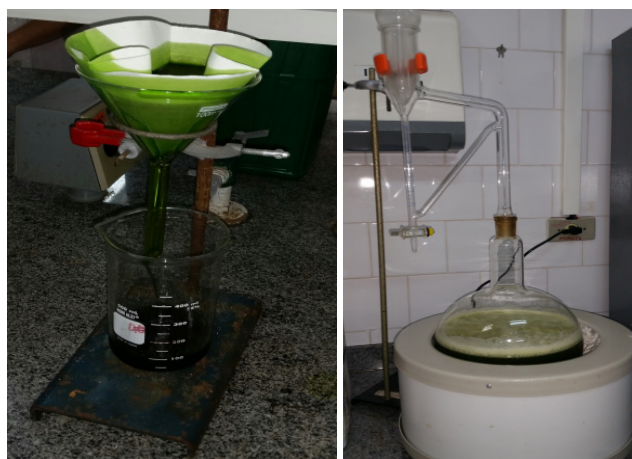
Figura 1. Filtragem de extrato de folhas e processo de hidrodestilação para obtenção de óleo essencial de Ocimum basilicum L.
