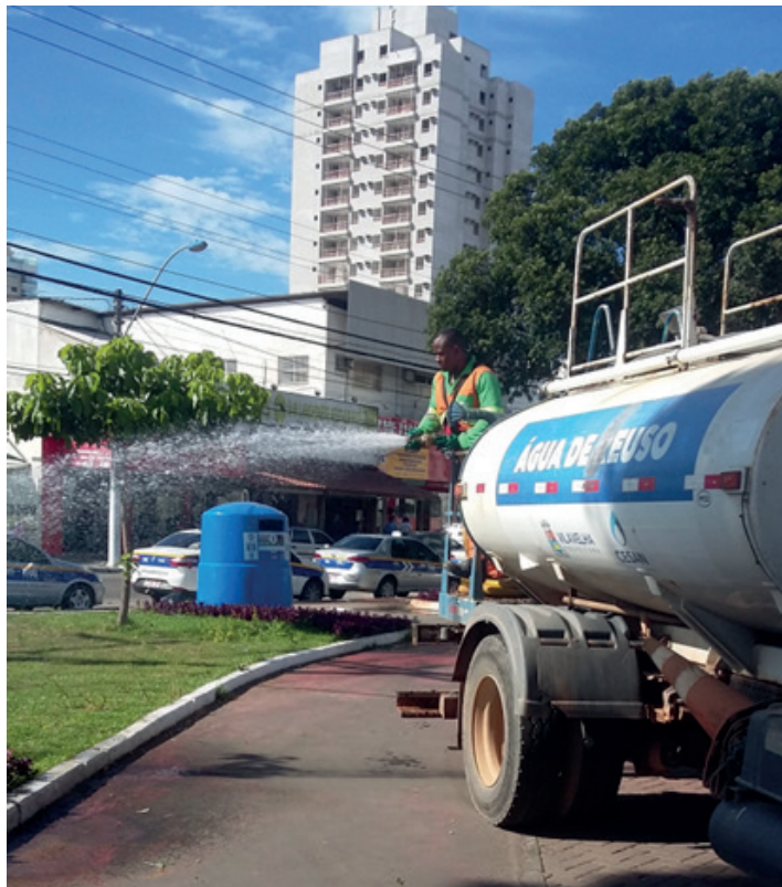
Figura 9. Irrigação de jardins com água de reúso.
