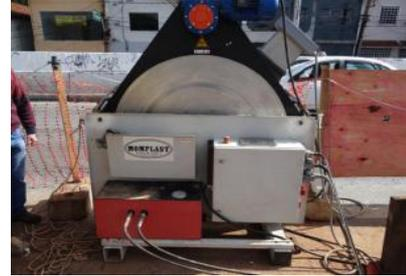
Figura 4: Placa de Aquecimento Máquina de termofusão
