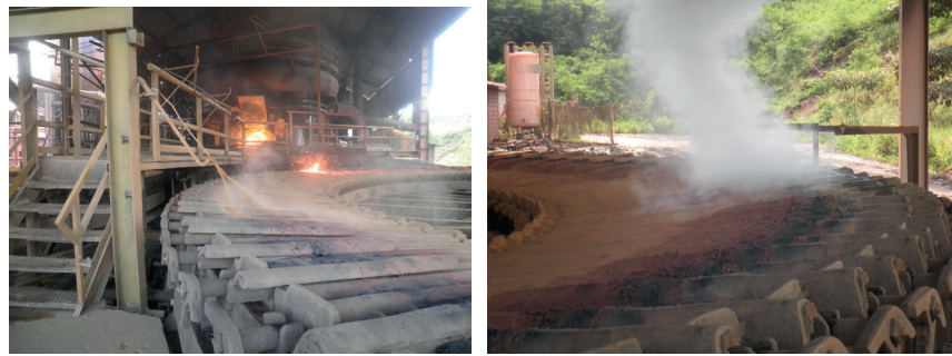
Figura 3 – A) Funcionário redirecionando o ferro fundido para o rodeio. B) Ferro fundido direcionado para o rodeio.
