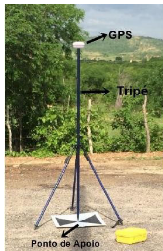
Figura 04-Alvo e GPS na execução das práticas
