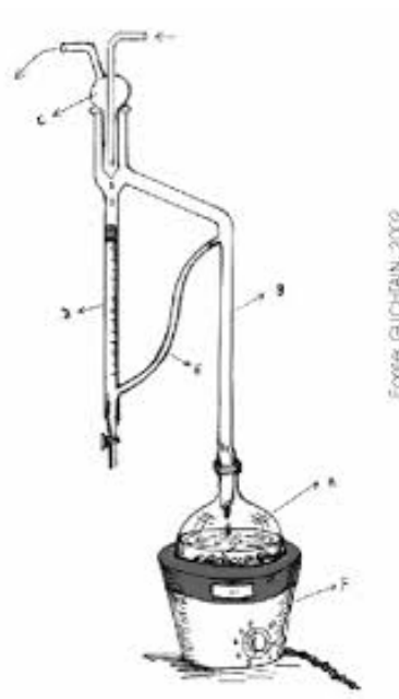
Figura 4: Aparelho de Clevenger, utilizado para extração do tipo hidrodestilação em escala laboratorial.
