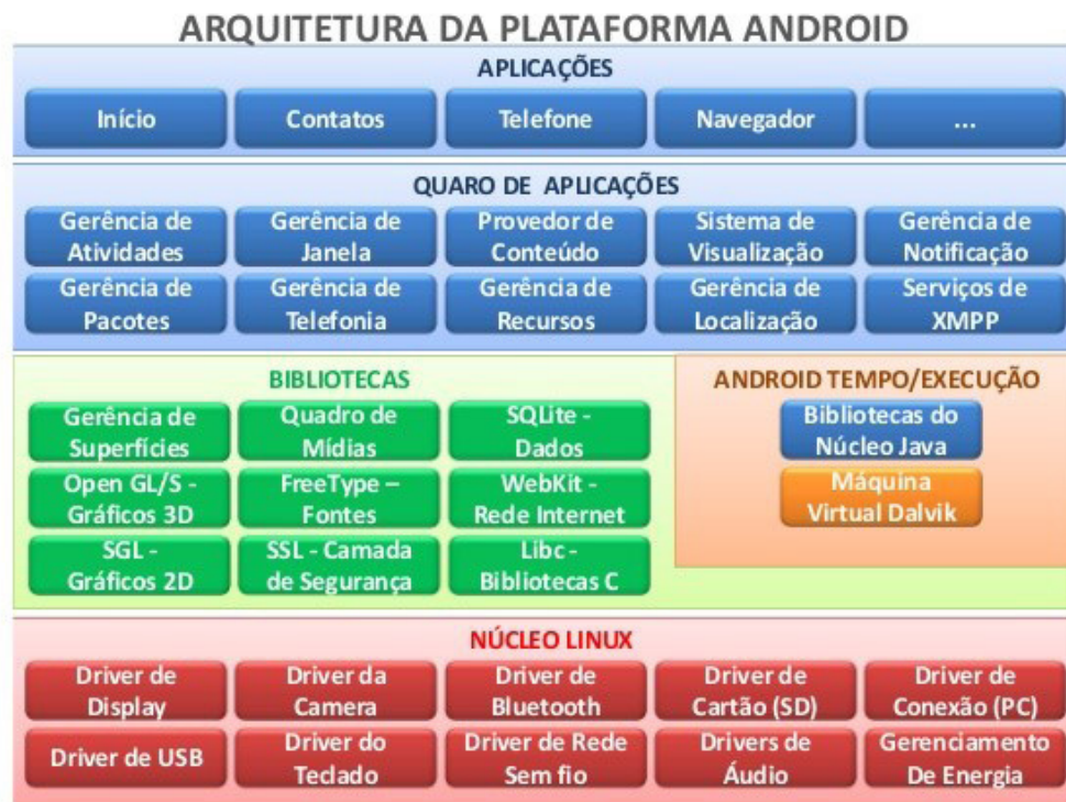
Figura 1: Arquitetura Android segundo suas camadas: Kernel (núcleo Linux), Bibliotecas, Android Runtime (tempo/execução), Framework de Aplicação e Aplicações.
