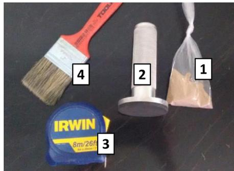
Figura 4- Materiais do ensaio da mancha de areia
