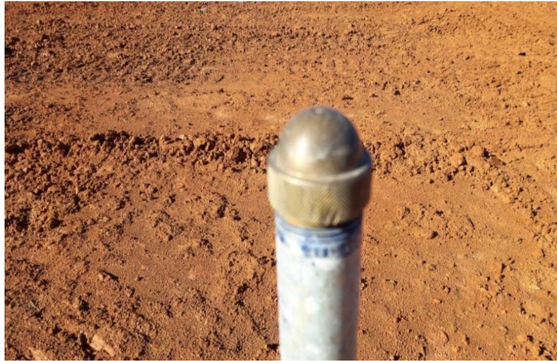
Figura 6- Apoio semi esférico para mira topográfica.
