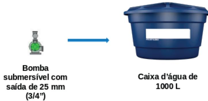
Figura 3: Sistema de captação de água antes da inclusão do filtro UV
