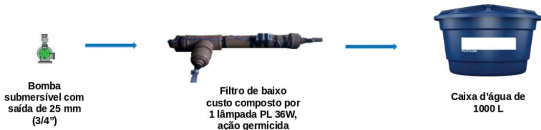
Figura 4: Fluxograma do sistema de filtração UV
