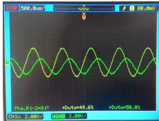
Figura 12 – Sinais analógicos dos canais A (amarelo) e B (verde) do encoder óptico. Tais sinais estão defasados entre si por um ângulo de 81^\circ devido ao deslocamento no sentido positivo (para à direita) da mesa cartesiana.
