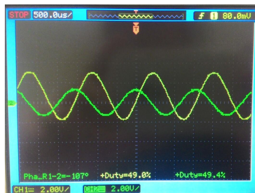
Figura 13 – Sinais analógicos e senoidais dos canais A (amarelo) e B (verde) do encoder óptico. Tais sinais estão defasados entre si por um ângulo de -107^\circ devido ao deslocamento no sentido negativo (para à esquerda) da mesa de varredura.
