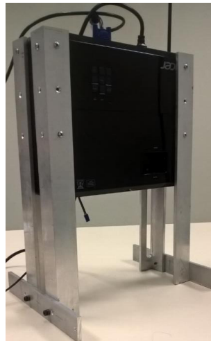
Figura 5 – Equipamento de litografia óptica pré-desenvolvido.
