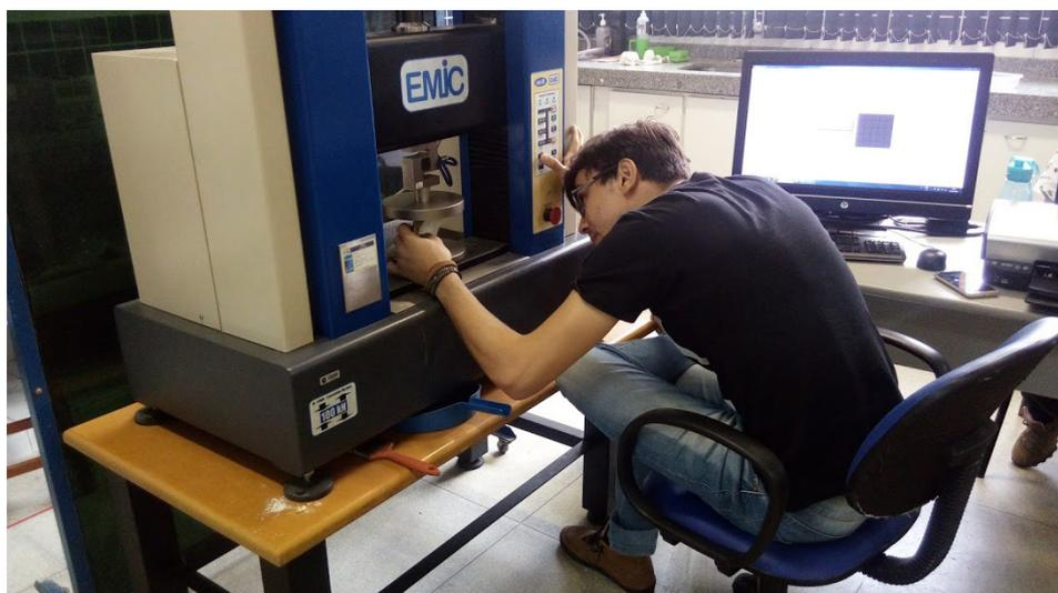
Figura 2 – Posicionamento da valve na placa de compressão, realizando ensaio em máquina universal de ensaios mecânicos destrutivos (EMIC®, Modelo DL 10000) localizado no Laboratório de Ensaio de Materiais da Universidade Federal do Vale do São Francisco (UNIVASF), *Campus Juazeiro* – Juazeiro, 2018.
