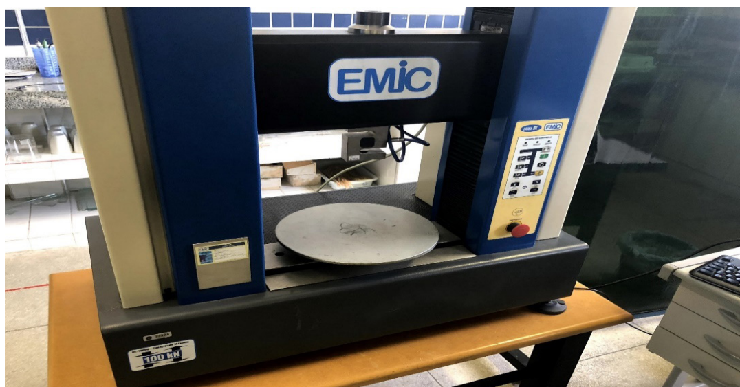
Figura 4 – Máquina universal de ensaios mecânicos destrutivos (EMIC ® , Modelo DL 10000), onde foram realizados os ensaio mecânicos destrutivos e seus resultados traduzidos mediante programa TESC ® , avaliando o grau de fratura em Newtons (N) e deformação em milímetros (mm) – Juazeiro (BA), 2018.
