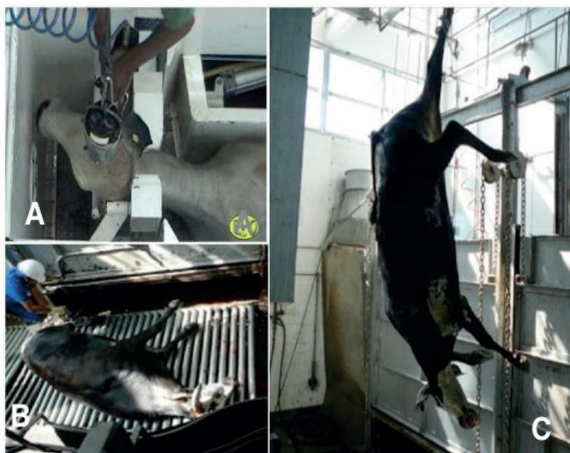
Figura 2: (A) Pistola pneumática, (B) Área de vômito, (C) Bovino pendurado pela trilhagem aérea denominada “Nória” parede lateral (movimento guilhotina ou basculante).
