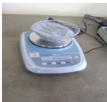
Figura 3: Pesagem do agregado reciclado para ensaio de granulometria
