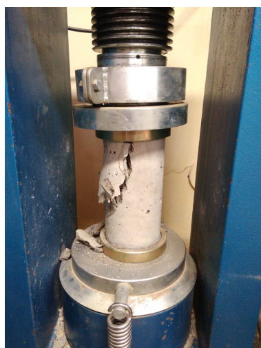
Figura 6: Ensaio de compressão Fonte - Próprio autor
