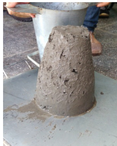
Figure 5: Ensaio de abatimento de tronco de cone Fonte - Próprio autor
