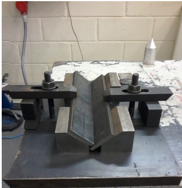
Figura 1 – Fixação e montagem do corpo de prova no dispositivo de solda
