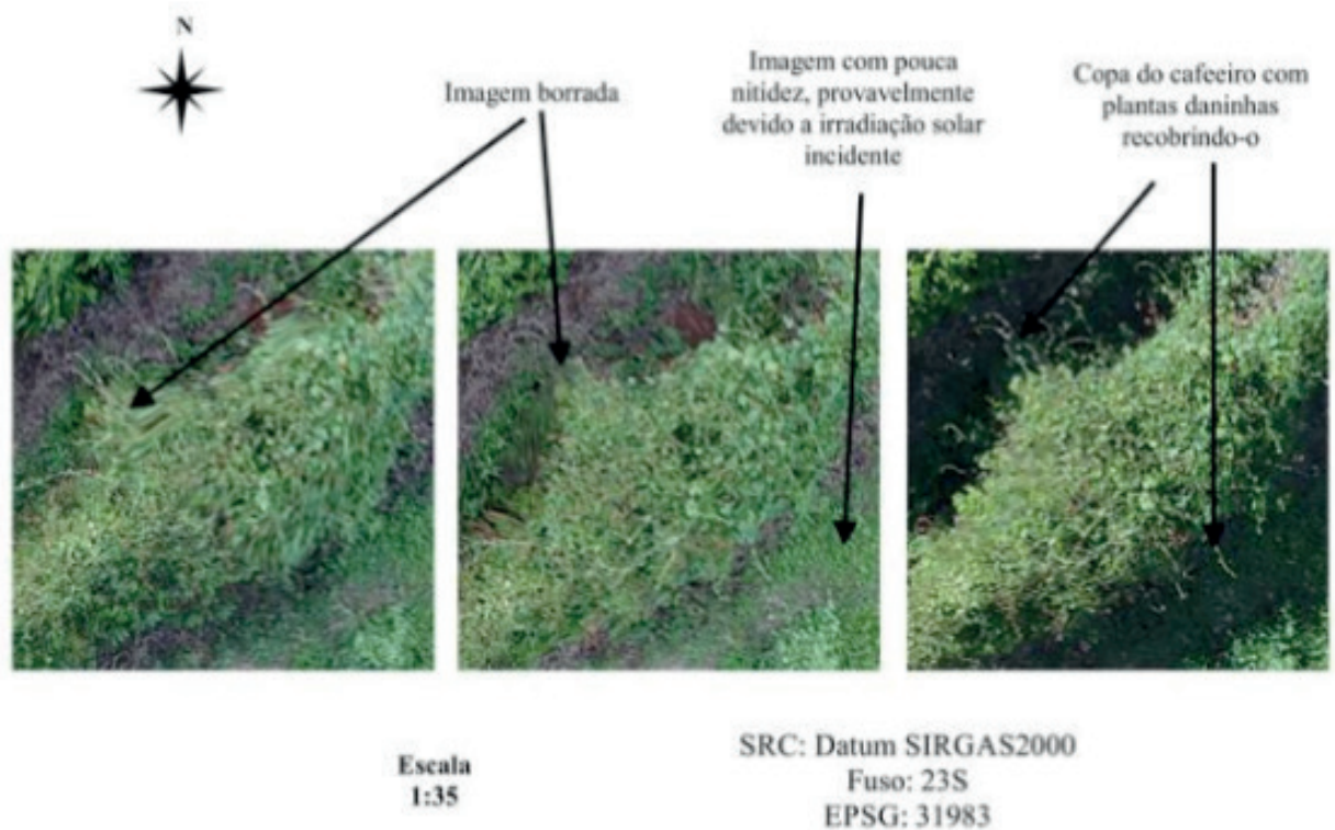
Figura 3- Detalhamento dos ortomosaicos resultantes dos parâmetros diferentes testados. A- Ortomosaico obtido do plano voo 1. B- Ortomosaico obtido do plano voo 2. C- Ortomosaico obtido do plano voo 3.
