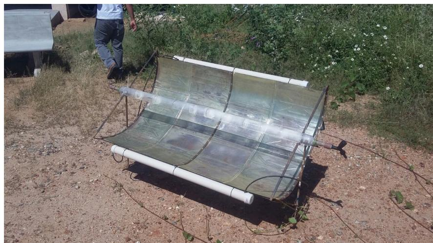
Figura 8. Reator Fotolítico com sistema de minibomba. IFPE, 2016.
