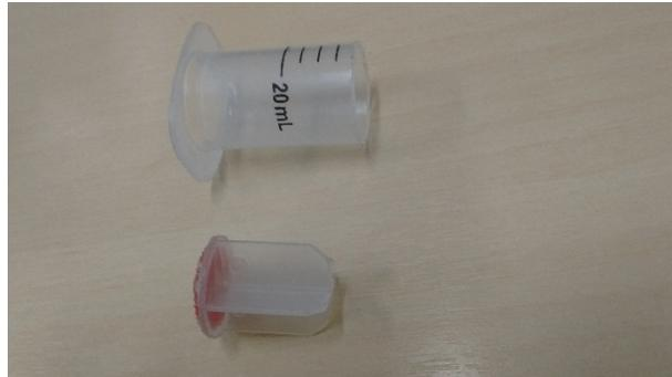
Figura 2. Corpo da seringa e o êmbolo (ROTOR), da minibomba. IFPE,2016.
