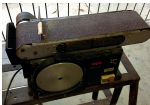
Figura 3: Lixadeira Skill utilizada na etapa de lixamento do corpo de prova.
