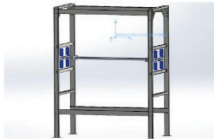
FIGURA 3- Diseño de estructura para ensayo dinámico y modelo de tablero puente.
