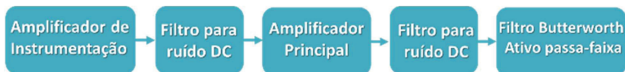
Figura 2. Estágios do processamento analógico.
