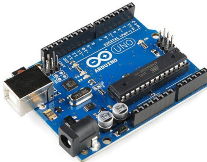
Figura 1: Plataforma Arduino, modelo Uno.
