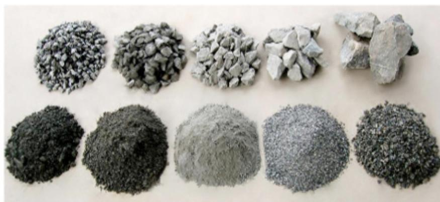
Figura 1 – Tipos de Britas com diferentes granulometrias.
