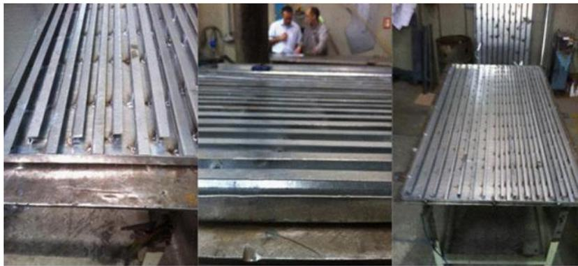
Figura 7 - Dutos fixados na chapa (SILVA et al., 2018b).
