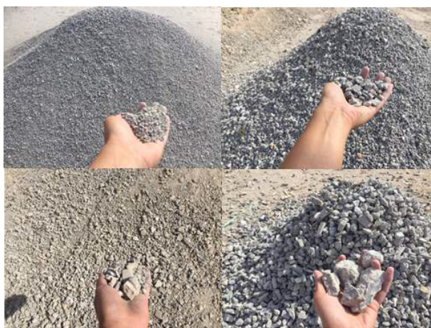
Figura 2. Material após o processo de trituração em diferentes granulometrias.
