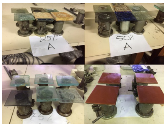
Figura 4. Corpos-de-prova de argamassa de cada traço executado.
