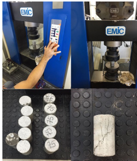
Figura 5. Ensaio de resistência à compressão simples em argamassas.
