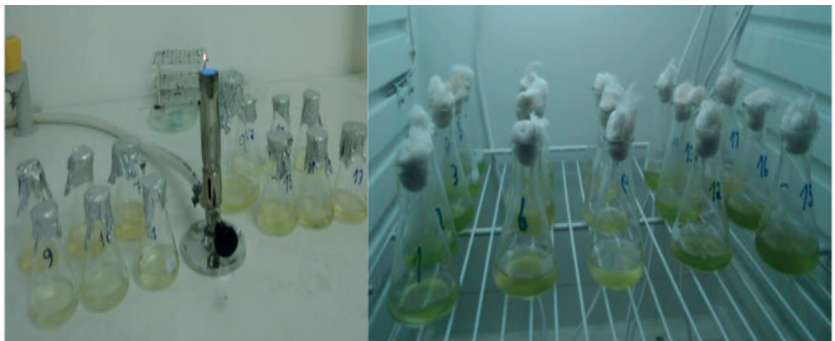
Figura 5A e 5B – Amostras a serem analisadas, 5 réplicas de controlo e 3 para cada uma das amostras da substancia, enumeradas, na câmara estufa, à 22°C, iluminada.
