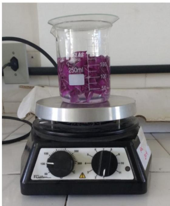
Figura 3: Sistema de extração por decocção.
