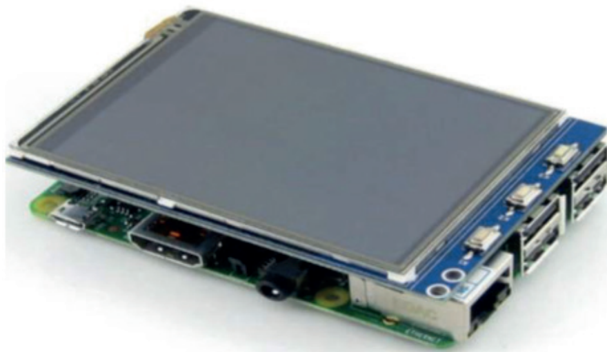
Figura 3. Display LCD touchscreen TFT de 3.2”
