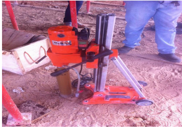
Figura 4 – Sonda para extração de corpos testemunhos de concreto
