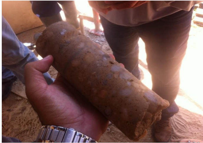
Figura 6 – Testemunho cilíndrico impróprio para ensaio
