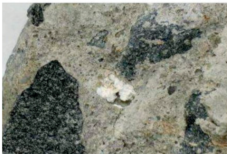
Figura 8 – Amostra ensaiada do concreto
