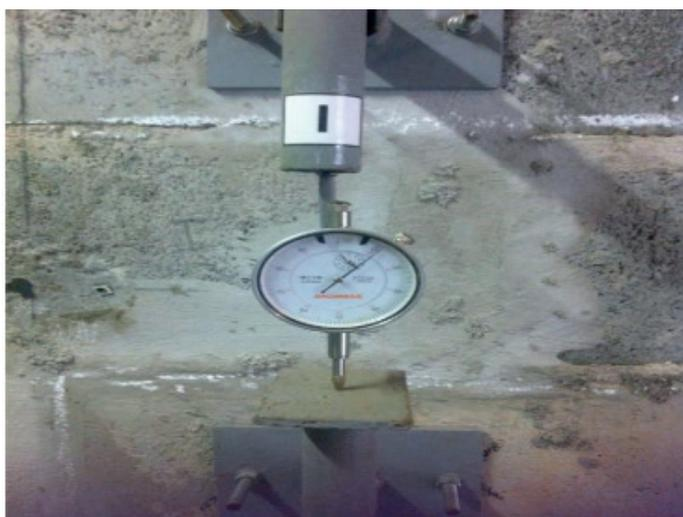
Figura 6 - Detalhe do relógio do deflectômetro.
