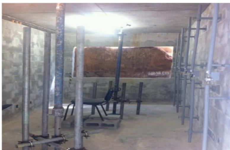
Figura 7 - Montagem deflectômetros para ensaio.
