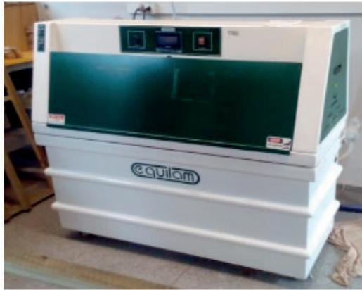
Figura 3 - Câmara de envelhecimento acelerado utilizada para a degradação dos corpos de prova (ESCOBAL, 2017)
