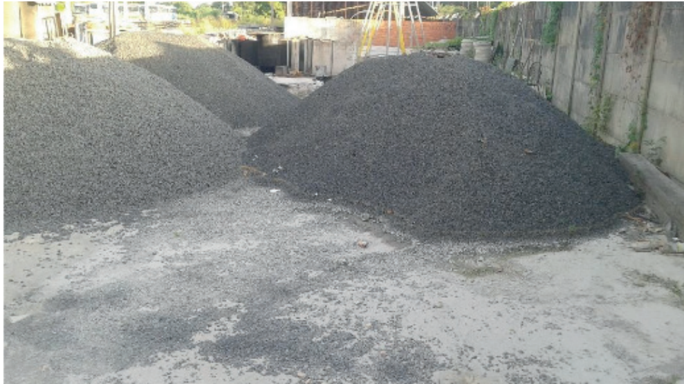
Figura 11 – Nota-se uma linha na base do monte de agregado, impurezas presentes no material/
