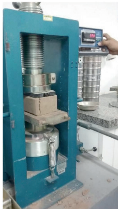
Figura 6- ensaio de compressão no tijolo (Fonte: Autoria própria )
