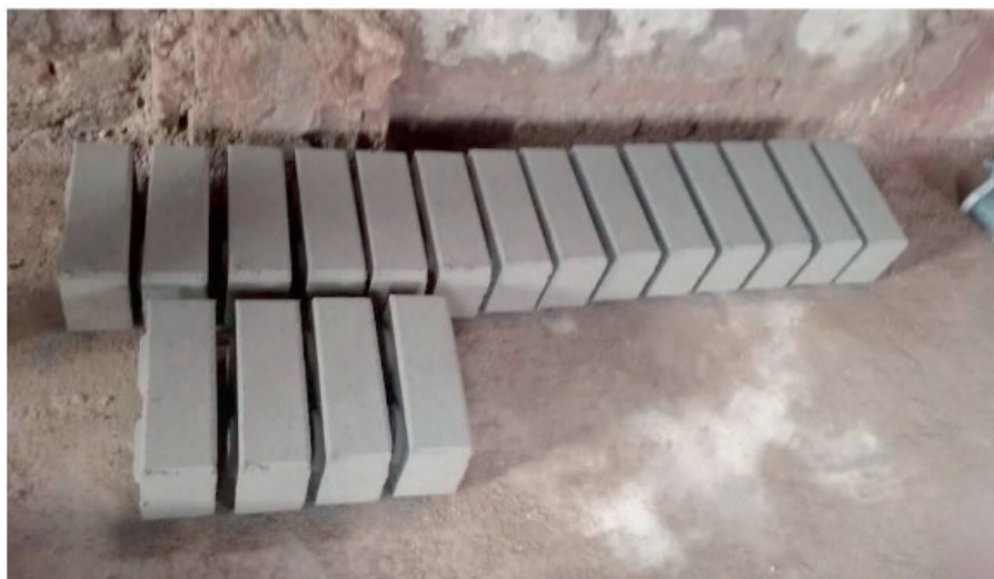
Figura 4 – Tijolo ecológico logo depois da prensagem (Fonte: Autoria própria)
