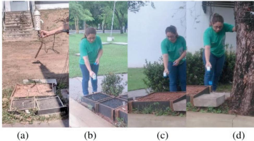
Figura 7 – Coleta de temperatura e umidade relativa do ar, por meio do transecto móvel (a) e coleta da temperatura superficial, por meio do termômetro digital a laser, revestimento de asfalto (b), revestimento de solo (c) e revestimento de concreto (d)
