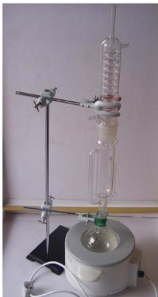
Figura 2. Reprodução de um sistema de extração Soxlet
