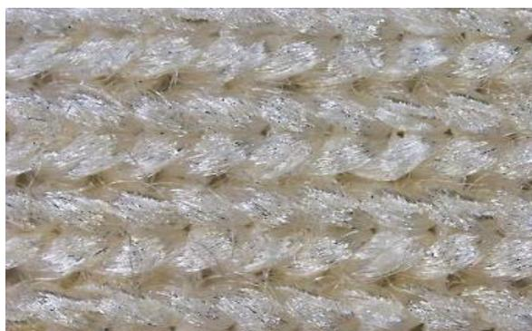
Figura 5: Estrutura do material têxtil composto por Polipropileno com Bambu (PP+BAM).
