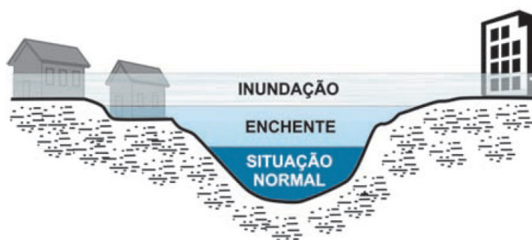
Figura 1: Perfil esquemático do processo de enchente e inundação
