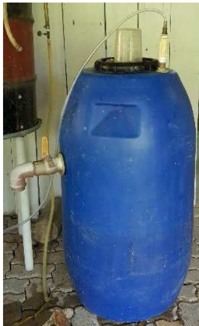
Foto 2 – Digestor anaeróbio construído em escala piloto.
