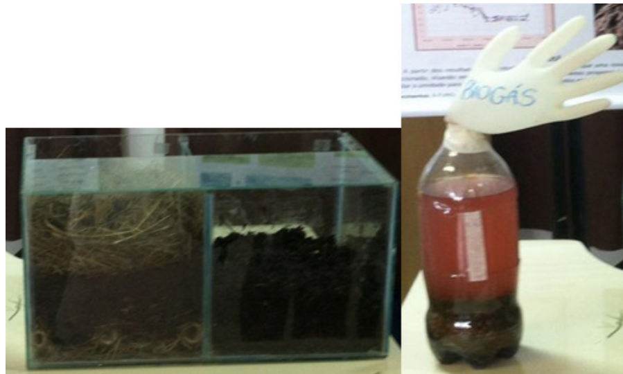
Foto 3 - Montagem de uma composteira (esquerda) e um digester anaeróbio (direita).
