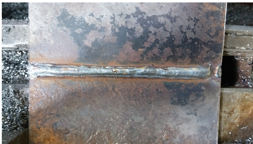
Figura 3. Cordão de solda da amostra 6.
