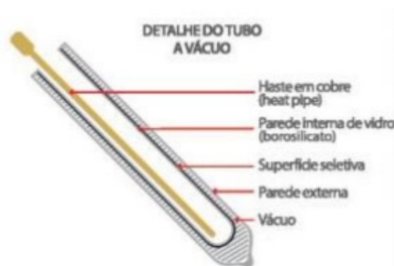
Figura 1 Estrutura do tubo de Borossilicato
