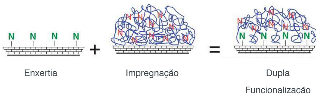
Figura 2- Representação esquemática do processo de enxertia, impregnação e dupla funcionalização.
