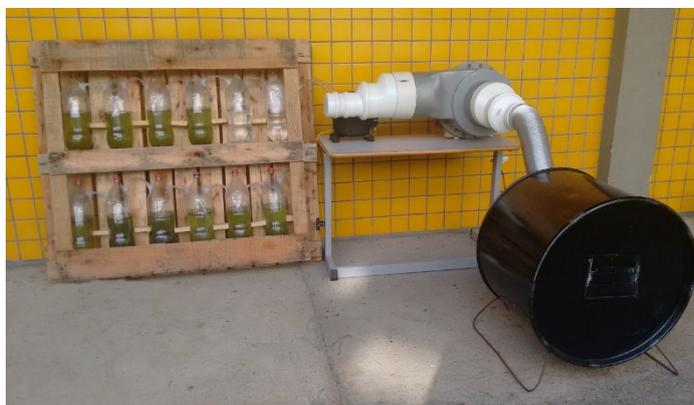
Figura 4: Protótipo do fotobiorreator de garrafa PET.
