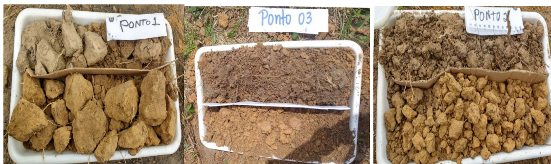
Figura 03 – Distinção de camadas de solo com diferentes características morfológicas. Fonte: Própria
