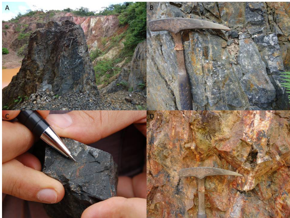
Figura 3: A – Afloramento brecha na cava antiga principal; B – Detalhe, matriz microcristalina e fragmentos de quartzo; C – Ouro visível em plano de fratura; D - Detalhe da zona oxidada.
