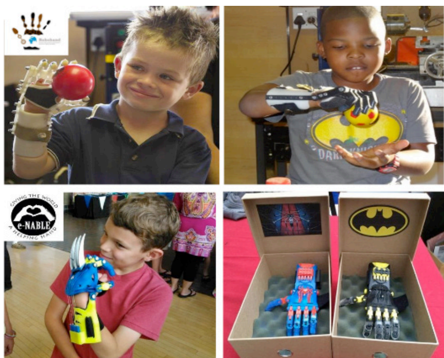
Fig. 1 – Prótese de mão mecânica infantil feitas por impressão 3D dos projetos Robohand e e-Nable.
