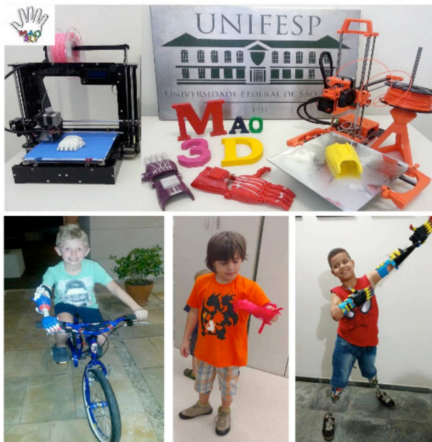
Fig. 2 – Próteses de mão mecânica infantil feitas por impressão 3D do Programa Mao3D.
