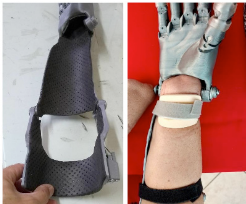
Fig.13 – Montagem final da prótese: revestimento interno e acessórios para fixação.
