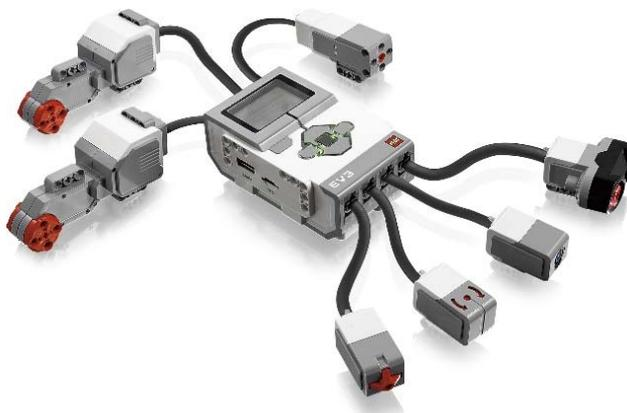
**Fig.02** – Motores e sensores conectados ao bloco programável EV3
