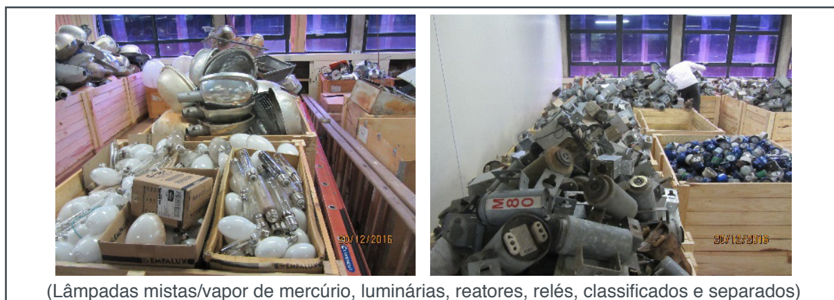
Figura 6 – Componentes do sistema de iluminação ao fim da vida útil, retirados de campo.
