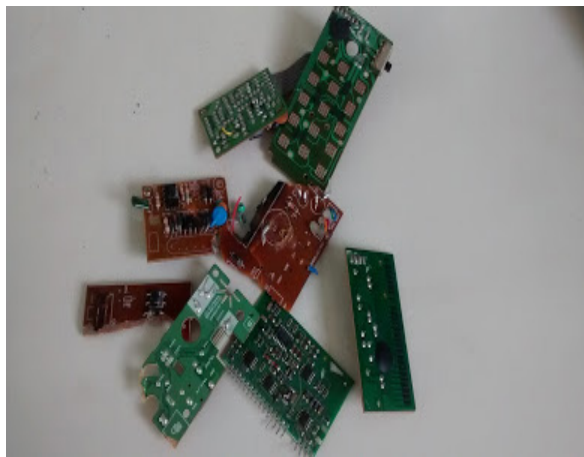
Figura 1: Placas de circuito impresso antes ao processo de cominuição.
